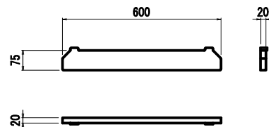
ゴムプレート（水平目地材） S=1:10 20×75×600
